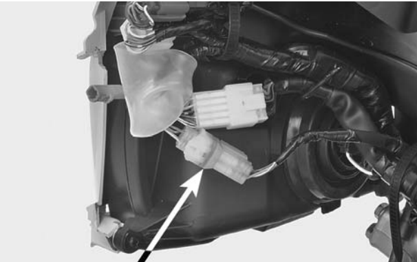
CONECTOR 4P (Transparente) RECEPTOR DO IMOBILIZADOR
